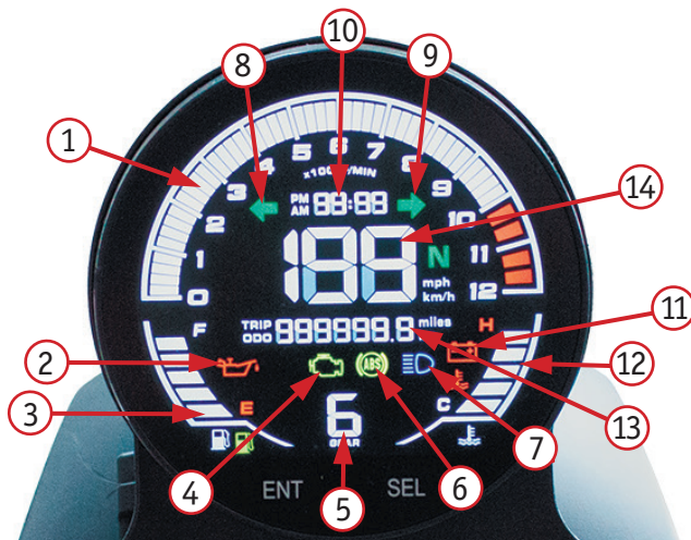
Фото 2.10. Вид приборной панели: 1 – тахометр; 2 – индикатор пониженного давления масла; 3 – количество топлива; 4 – индикатор неисправности EFI; 5 – индикатор передачи; 6 – индикатор ABS; 7 – индикатор дальнего света; 8 – индикатор левого поворотника; 9 – индикатор правого поворотника; 10 – время; 11 – индикатор напряжения; 12 – температура двигателя; 13 – общий/текущий пробег; 14 – скорость
