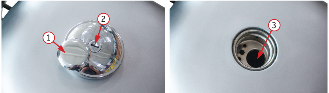
Фото 2.6. Топливный бак: 1 - защитная створка замочной скважины топливного бака; 2 - замочная скважина топливного бака; 3 - горловина топливного бака;
