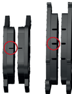
Фото 5.10. Определение износа тормозных колодок
