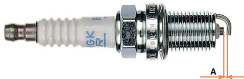
Фото 5.3. Зазор «А» между электродами свечи зажигания
