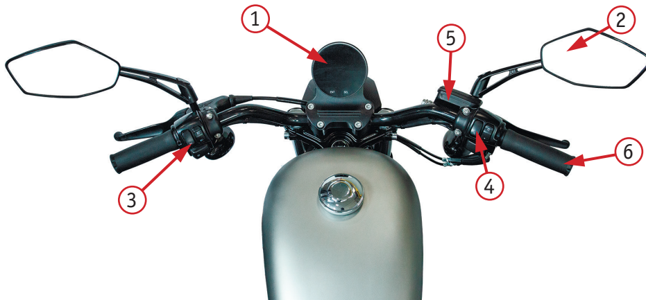
Фото 2.1. Вид руля и органов управления мотоцикла: 1 – приборная панель; 2 – зеркало заднего вида; 3 – левый комбинированный переключатель; 4 – правый комбинированный переключатель; 5 – бачок для тормозной жидкости; 6 – рукоятка газа (акселератор)
