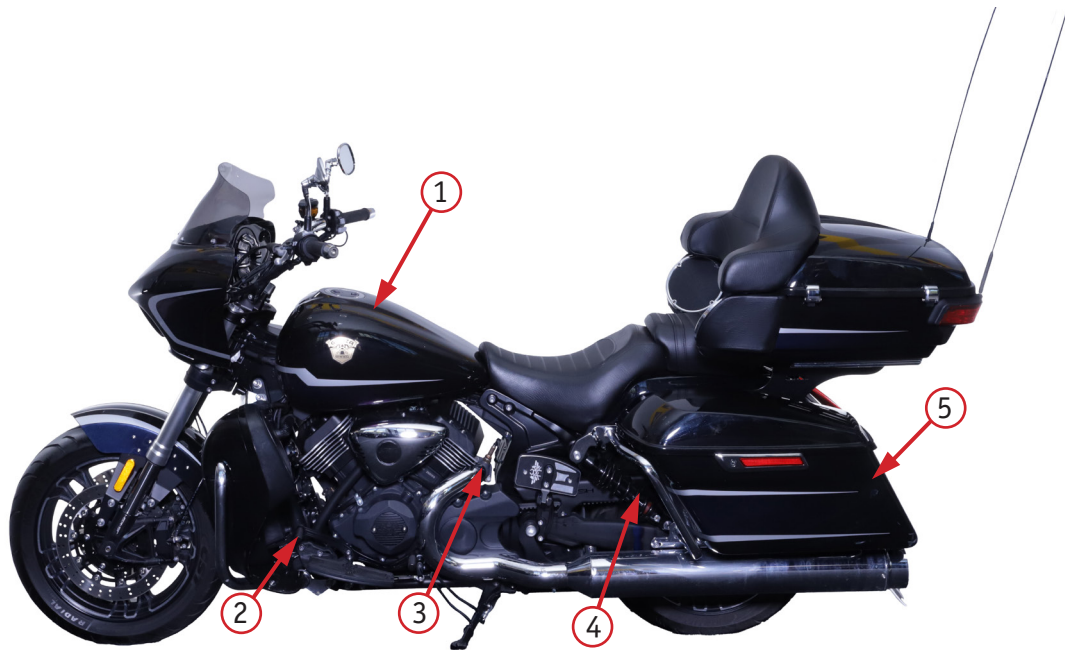
Фото 2.3. Вид слева: 1 – топливный бак; 2 – рычаг переключения передач; 3 – датчик кислорода; 4 – задний амортизатор; 5 – крепление номерного знака
