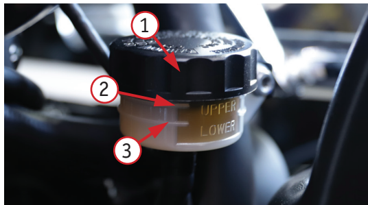
Фото 5.7.2 Уровень тормозной жидкости заднего тормоза: 1 – крышка; 2 – максимум; 3 – минимум
