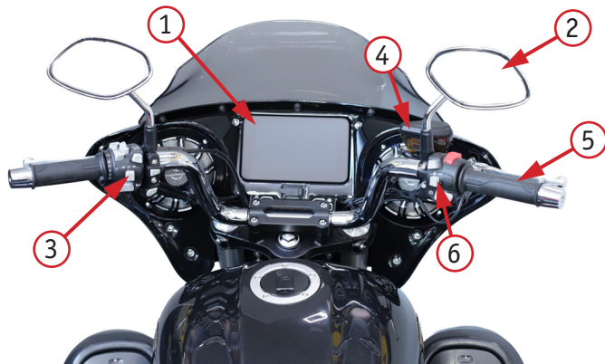
Фото 2.1. Вид руля и органов управления мотоцикла: 1 – приборная панель; 2 – зеркало заднего вида; 3 – левый комбинированный переключатель; 4 – бачок для тормозной жидкости; 5 – рукоятка газа (акселератор); 6 – правый комбинированный переключатель
