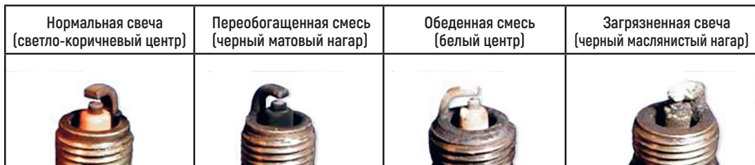
Фото 5.1. Состояния свечей зажигания
