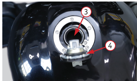
Фото 2.6. Топливный бак: 1 – защитная створка замочной скважины топливного бака; 2 – замочная скважина топливного бака; 3 – горловина топливного бака; 4 – крышка топливного бака в открытом виде
