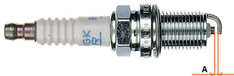
Фото 5.2. Зазор «А» между электродами свечи зажигания
